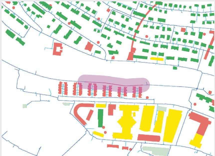
Fig. 1 Einfärbung der Gebäude nach Wichtigkeit und Darstellung des Gefährdungsradius einer Leitung DN 800 Grauguss. In diesem Fall sind die Einfamilienhäuser einer denkmalgeschützten Siedlung (Bernoulli-Siedlung) speziell betroffen.
