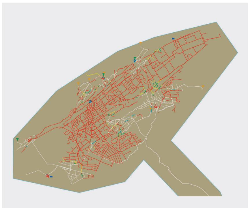
Fig. 3 Farbliche Darstellung der Kontaminationsverteilung in einem teilgespülten Netz des ESB (rote Leitungen sind in der Simulation momentan noch stark verunreinigt und werden mit fortschreitenden Spülungen wieder gereinigt)
