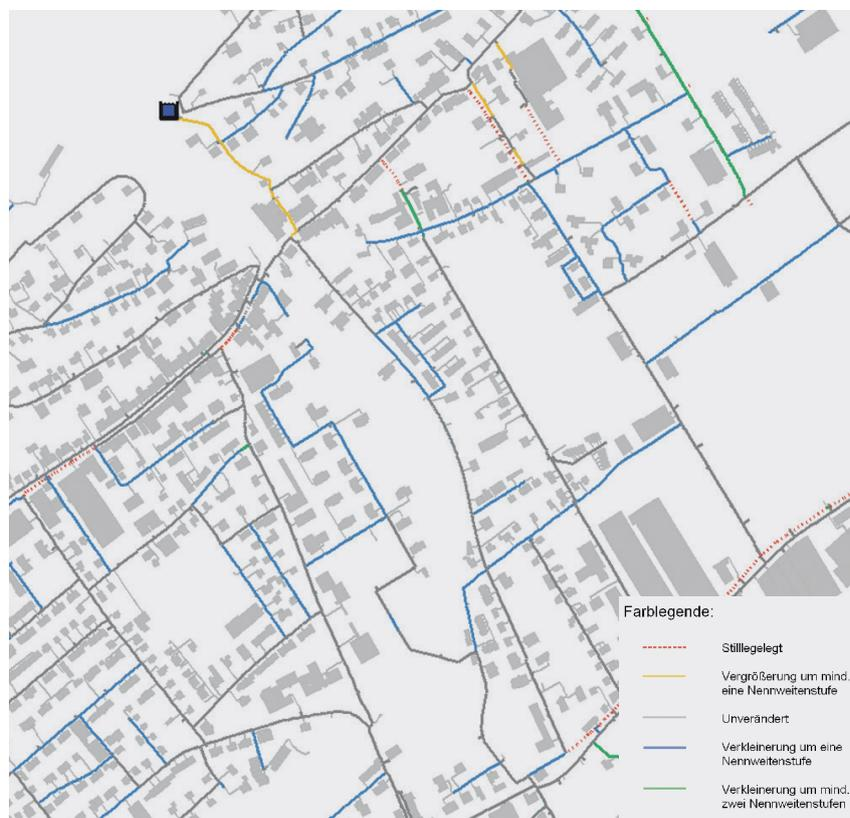
Fig. 4 Grafische Darstellung der Optimierungsergebnisse einer Zielnetzuntersuchung
