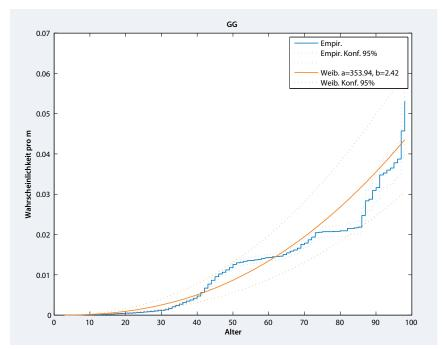
Abb. 2 Altersabhängige Ausfallwahrscheinlichkeit von Graugussleitungen
