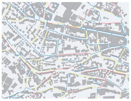
Abb. 6 Reihenfolge der zu erneuernden Leitungsabschnitte in einem Wassernetz
