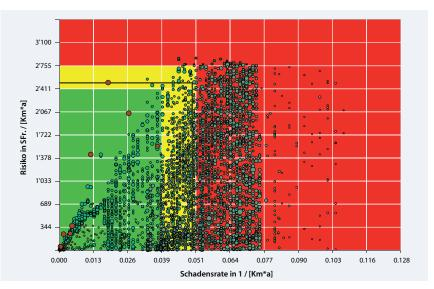
Abb. 4 Risiko-Schadensratendiagramm eines Wassernetzes
