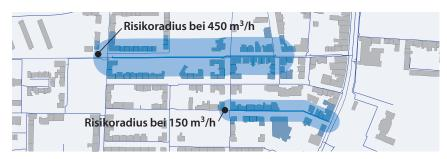
**Abb. 3** Risikoradien von Wasserleitungen in Abhängigkeit von der austretenden Wassermenge im Fehlerfall
